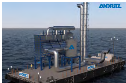
Die SeaSO x -Barge legt an Schiffe auf Reede oder im Hafen an und saugt die Abgase von Bord
